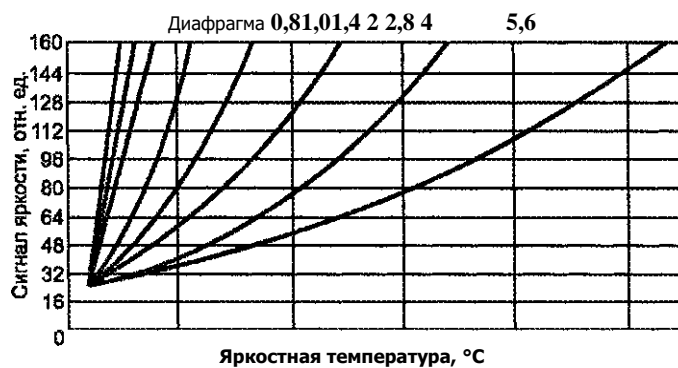
Рисунок Б.2 — Градуировочный график пировидиконной камеры с фильтром № 2
